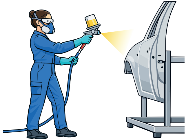
Mit der Sprühpistole wird die Lackschicht auf das zu lackierende Produkt von Hand aus aufgebracht.
