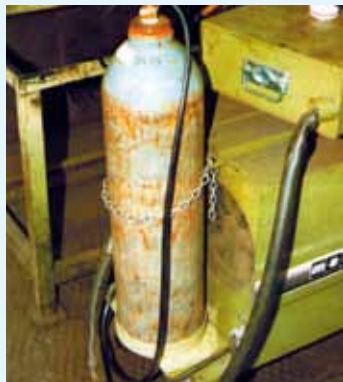
Schutzgasschweißgerät mit sicher befestigter Schutzgasflasche
