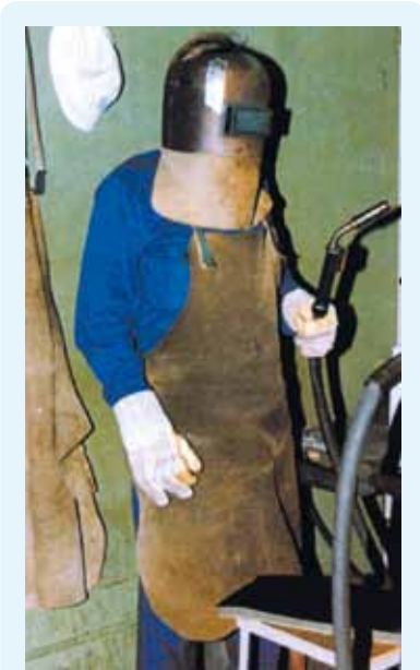
Schweißer mit persönlicher Schutzausrüstung, die den gesamten Körper auch gegen die ultraviolette Strahlung schützt
