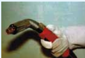
Schutzgasschweißpistole mit integrierter Absaugung
