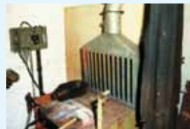
Schweißstisch mit integrierter Absaugung
