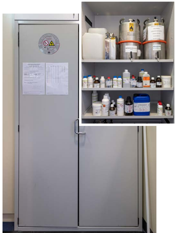
Abb. 16 u. 17: Lagerung von brennbaren Flüssigkeiten im Sicherheitsschrank
