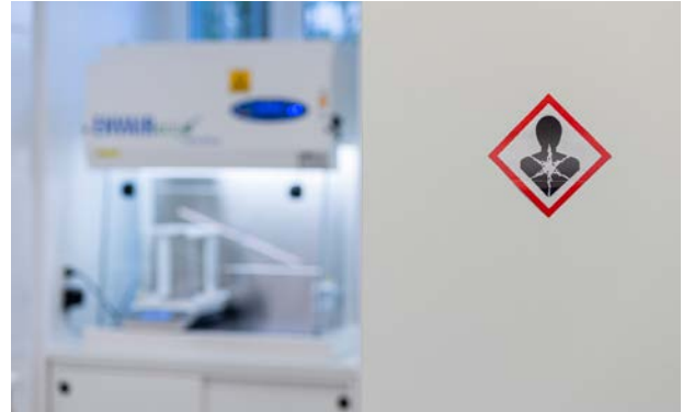
Abb. 13: Bereichskennzeichnung für Räume, in denen mit CMR-Stoffen umgegangen wird
