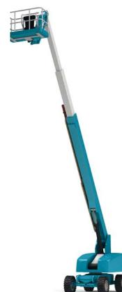
Bei unvorhergesehenen Ereignissen (Kollision mit anderen Fahrzeugen, einbrechen oder einsinken der Räder, fahren über Hindernisse etc.) kann der Bediener durch den Katapulteffekt aus dem Arbeitskorb geschleudert werden!
