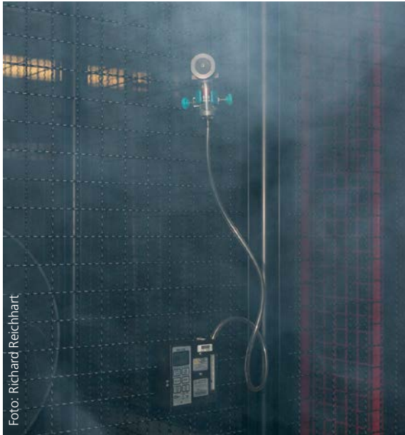
Abb. 7: Beispiel für eine Messung des MAK-Wertes in Atemhöhe mit Hilfe einer Kombination aus Luftpumpe und GSP-Probenahmekopf
