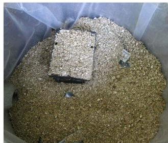
Lagerung einer Batterie in einem Metallkübel mit Vermiculit
