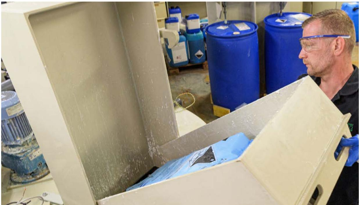
Abb. 3 und 4: Mit einer geschlossenen Schütte lässt sich die Staubentwicklung bei der Befüllung mit gefährlichen, pulverförmigen Arbeitsstoffen vermeiden.
