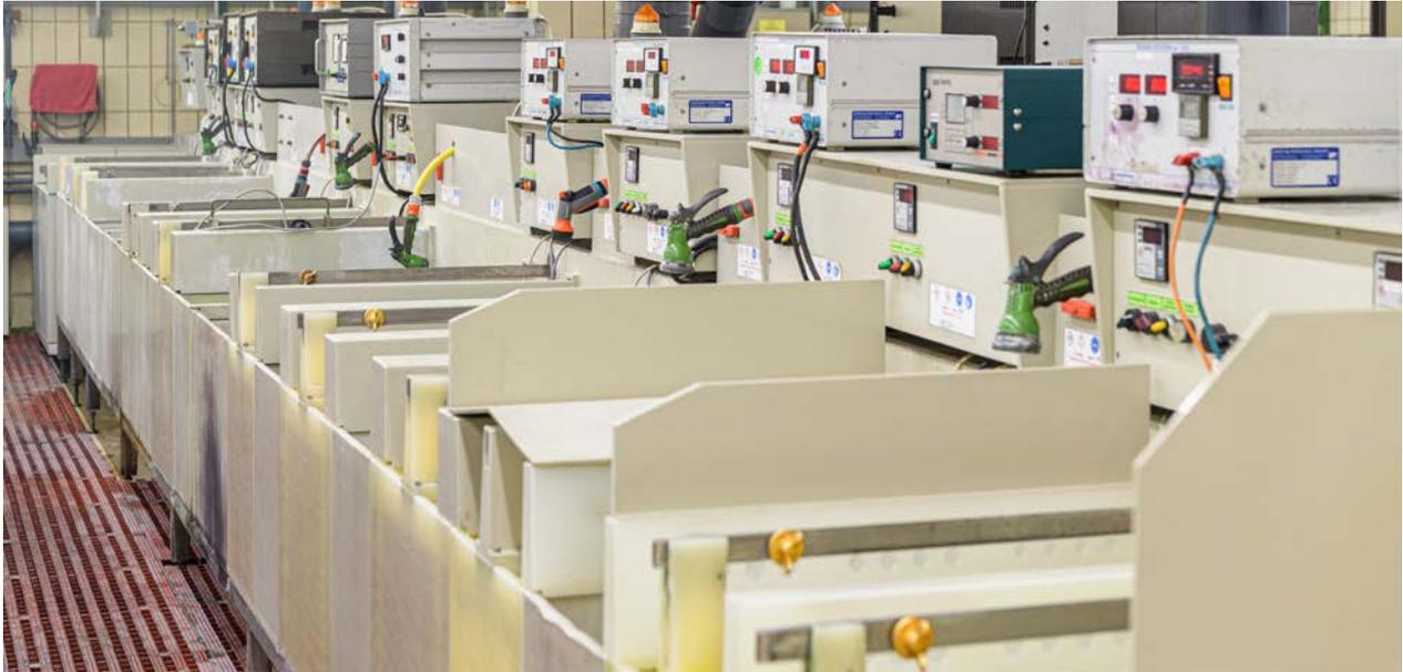
Abb. 7: Ein durchlässiger Industrieboden mit entsprechendem Gefälle sorgt dafür, dass sich Flüssigkeiten nicht am Boden sammeln können, sondern direkt zur Entsorgung bzw. Aufbereitung abgeleitet werden.
