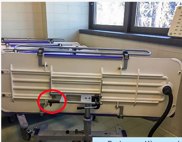
Feder am Kippmechanismus einer Duschieliege
