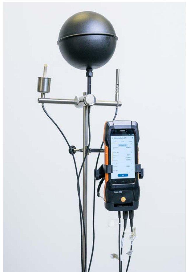
Bild 5: In Österreich handelsübliches WBGT-Messgerät mit standardisiertem Schwarzglobe-Thermometer
