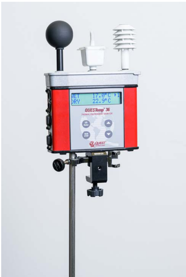
Bild 4: Einfaches, handliches WBGT-Messgerät mit kleinem Schwarzglobe-Thermometer
