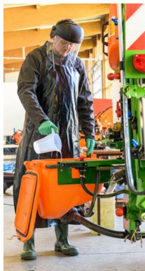
Abb. 5+6: Einfüllen des PSM-Konzentrats direkt in den Pflanzenschutzgerätetank (li.) und über eine Einspülschleuse (re.)
