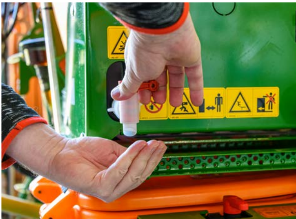
Abb. 13: In Feldspritze integrierter Frischwasserbehälter mit Auslasshahn
