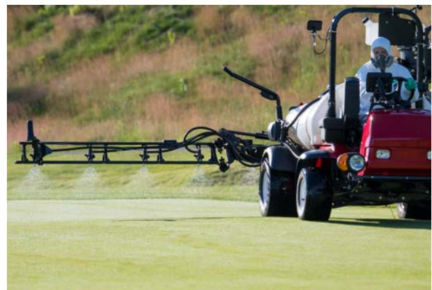
Abb. 14: Bei der Ausbringung von PSM (z. B. Rasenspritzung) mit einem offenen Spritzwagen ist PSA in vollem Umfang zu tragen.
