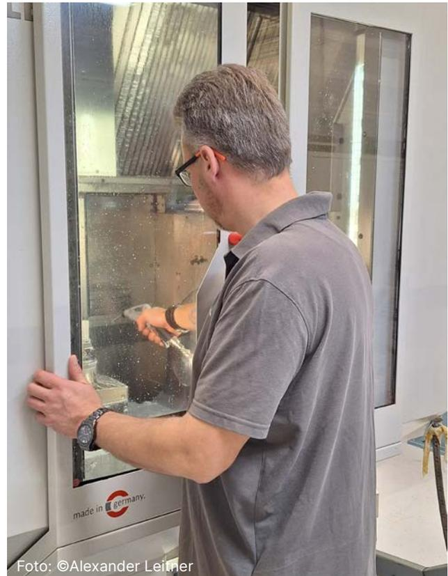
Abbildung 8: Richtiges Abblasen von Werkstücken
