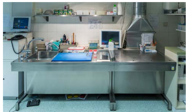
Abb. 11: Abgesaugter Lochblechtisch mit zwei nebeneinander liegenden Arbeitsplätzen
