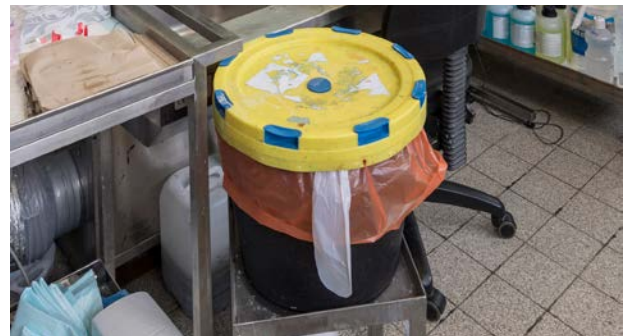
Abb. 17: Ein verschlossener Mülleimer für in Formalin getränkte Tücher oder Handschuhe vermeidet das Abdampfen
