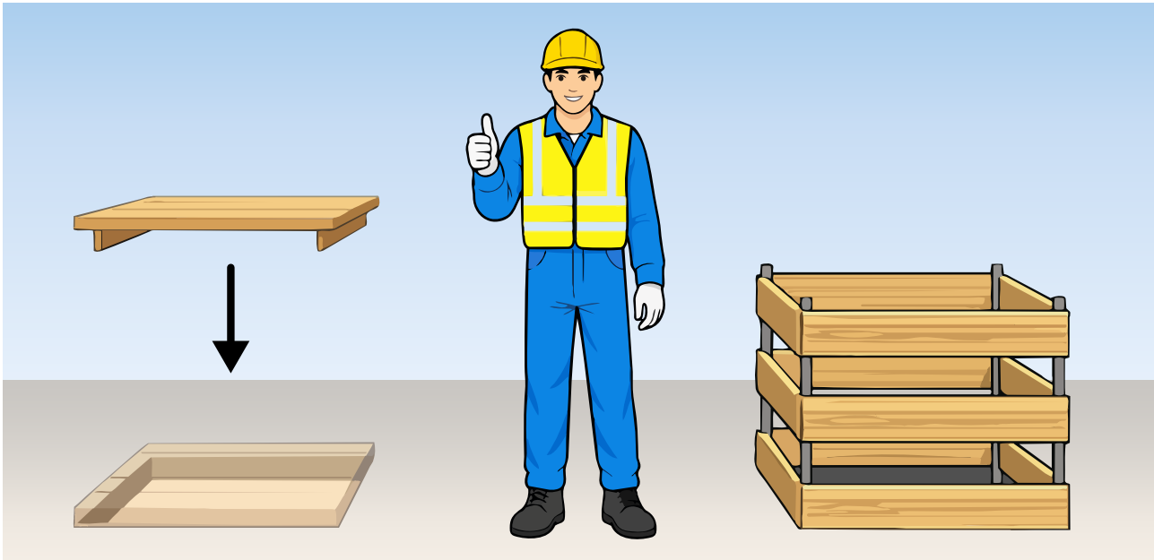
Absturzsicherung an Boden- und Deckenöffnungen
