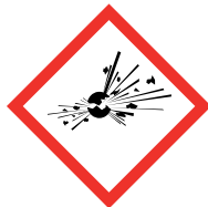
Gefahr instabil, Explosionsgefahr
