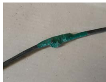
Abb. 10: Defekte und nicht fachgerecht reparierte Stromleitung
