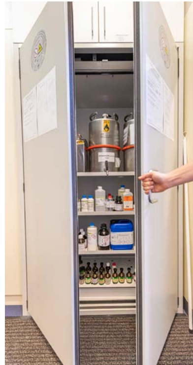
Abb. 13: Sicherheitsschrank zur Lagerung gefährlicher Arbeitsstoffe (hier brennbare Flüssigkeiten)
