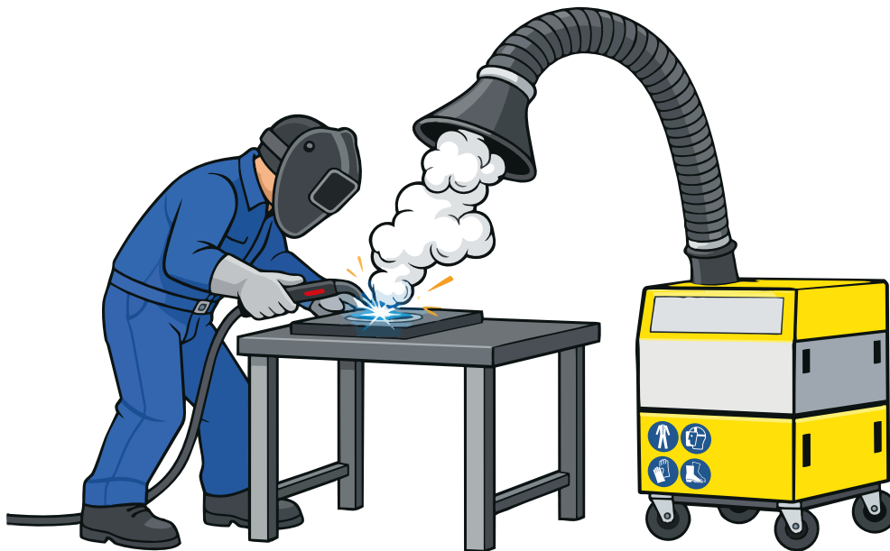
Schweißarbeitsplatz mit Absaugung
