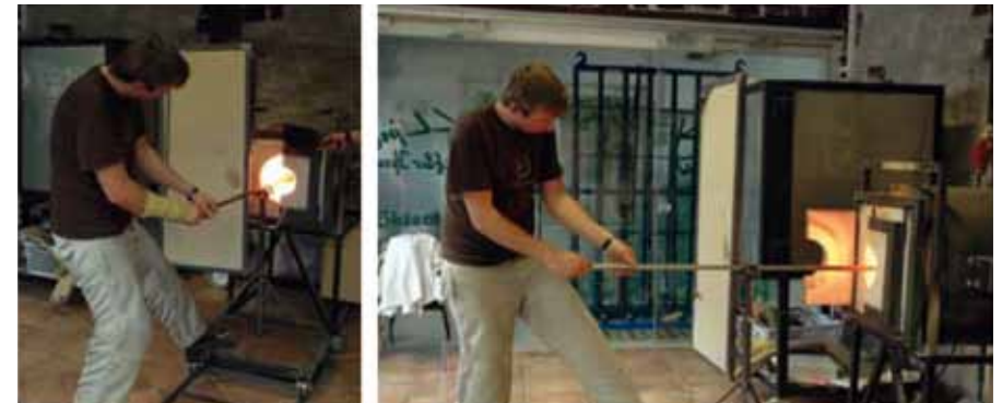
Abb. 20: Zum Schutz des Glasmachers vor übermäßiger Strahlung ist vor der Aufwärmtrommel (Innentemperatur 1200 °C) eine Abschirmung angebracht.
