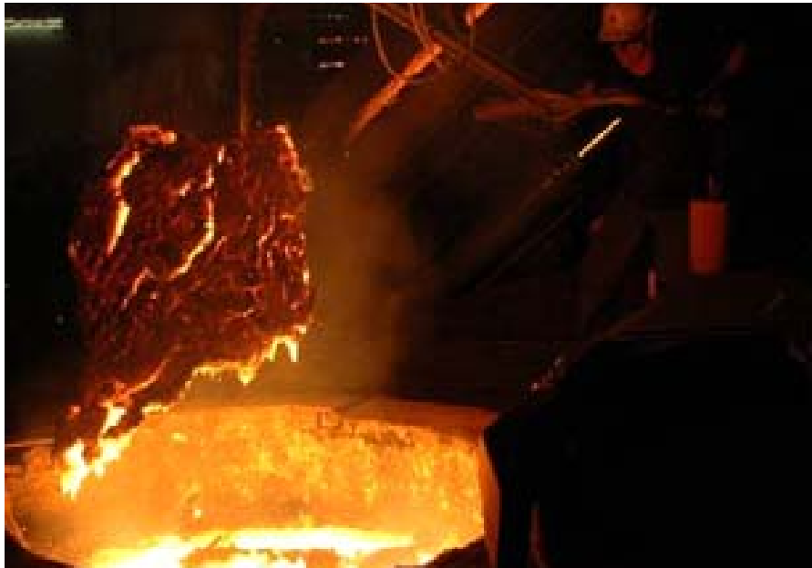
Abb. 16: Abschlacken bei einem Schmelzofen in einer Eisengießerei.
