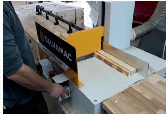
Abb. 21: Leises und sicheres Arbeitsverfahren: Kappsäge mit Zwei-Handbedienung und Sägeblatt unter der Tischauflage. Das Holz wird automatisch mit der Schutzabdeckung festgehalten.
