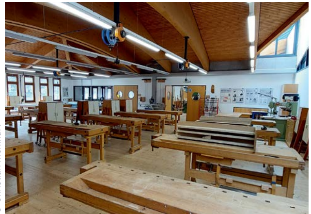
Abb. 17: Montageraum mit geringerem Schallpegel, nur kleine handgeführte Maschinen und Werkzeuge
