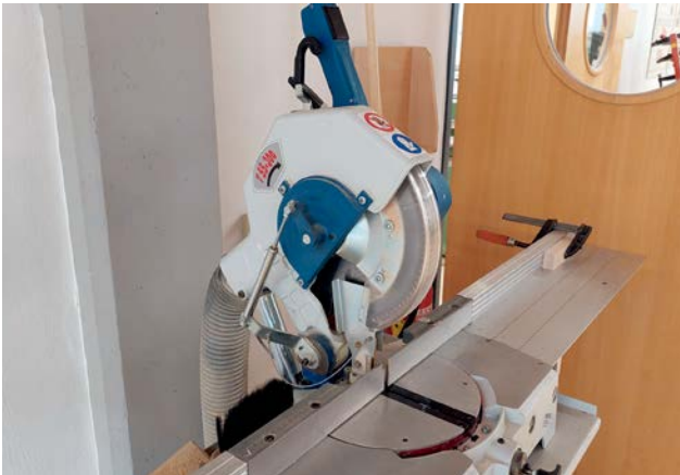
Abb. 20: Lautes Arbeitsverfahren mit höherem Verletzungsrisiko: Kapp- und Zugsäge mit Handbedienung und freiem Sägeblatt. Das Holz muss mit der Hand festgehalten werden.
