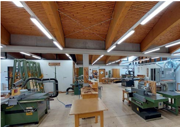
Abb. 16: Maschinenraum mit hohem Schallpegel, mit Kreissäge, Hobelmaschine, Fräsmaschine, Bandschleifmaschine, Bandsäge, CNC Maschine, ...
