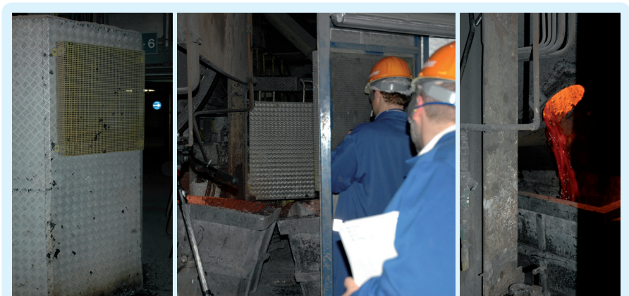
Abb. 12: Abschirmwand/Abschirmkabine: Während des Salzabgusses (siehe ganz rechts) befindet sich der AN hinter der Abschirmwand (siehe Mitte bzw. Vorderansicht Abschirmwand links), wo die Wärmestrahlung deutlich reduziert ist.
