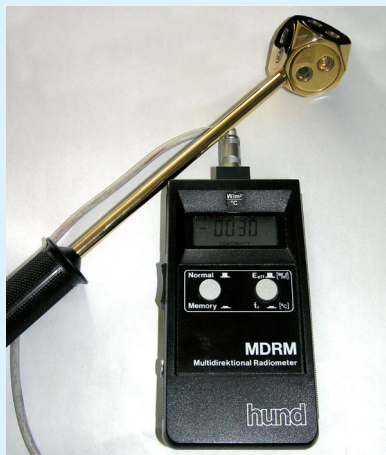
Abb. 9: Deltaradiometer MDRM (Multidirektionales Messgerät) der Firma Hund zur Messung der effektiven Bestrahlungsstärke. Das Deltaradiometer gibt den Durchschnitt der effektiven Bestrahlungsstärke unter Berücksichtigung von sechs Raumrichtungen aus.
