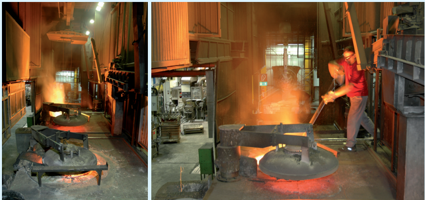
Abb. 10: In Gießereien und Schmelzereien sind Arbeitnehmerinnen und Arbeitnehmer vor allem der Wärmestrahlung der heißen Metallschmelze sowie der Ofenauskleidung exponiert.
