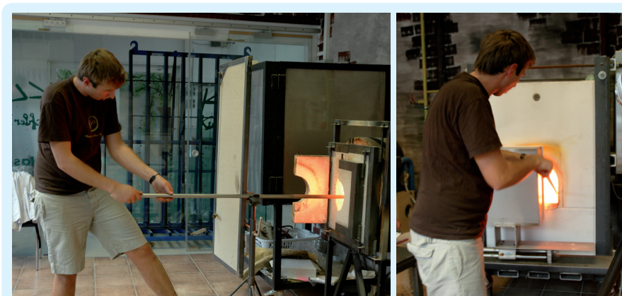
Abb. 11: Ein Glasmacher ist vor allem beim Aufwärmen des Glases beim Aufwärmofen (linkes Bild) sowie bei der Entnahme des Glases aus dem Schmelzofen (rechtes Bild) einer hohen Wärmestrahlung exponiert.
