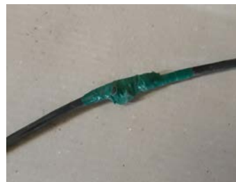
Abb. 11: Defekte und nicht fachgerecht reparierte Stromleitung
