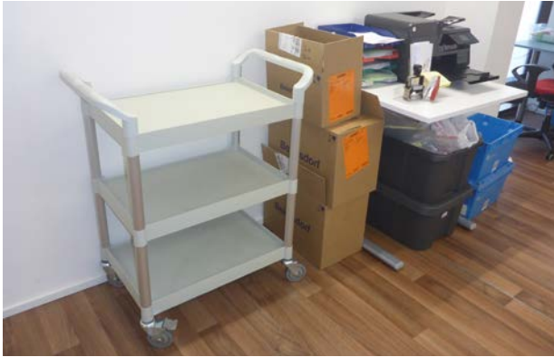
Abb. 20: Transport-Rollwagen mit hochgezogenen Regalbodenkanten
