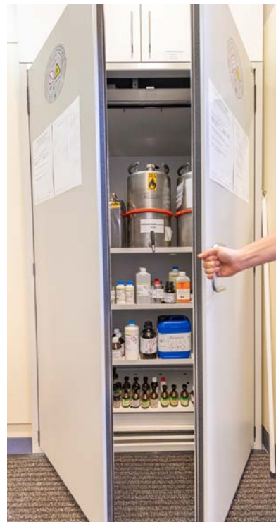
Abb. 14: Sicherheitsschrank zur Lagerung gefährlicher Arbeitsstoffe (hier brennbare Flüssigkeiten)
