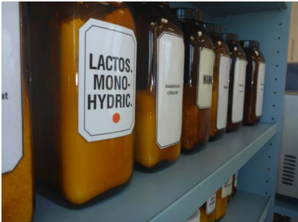
Abb. 24: Regalbodenkanten als Schutz vor Herunterfallen gefährlicher Arbeitsstoffe
