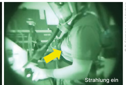
Die Infrarotaufnahmen vom handgeführten Laserreinigen zeigen: Nur mittels Infrarotsichtgerät wird die unsichtbare Streustrahlung (weiße Bereiche im rechten Bild) des Lasers sichtbar.
