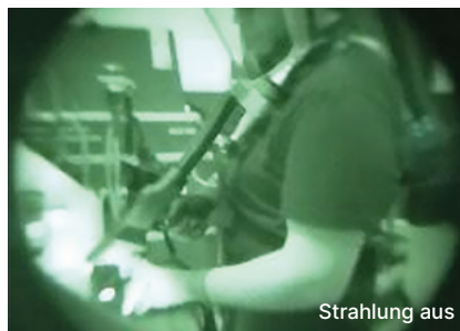
Die Infrarotaufnahmen vom handgeführten Laserreinigen zeigen: Nur mittels Infrarotsichtgerät wird die unsichtbare Streustrahlung (weiße Bereiche im rechten Bild) des Lasers sichtbar.
